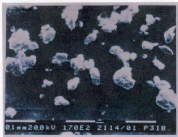
Gambar 2 SEM selulosa mikrokrystal perbesaran 170 kali.
