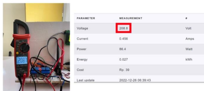
Gambar 3.5 Mengukur Tegangan Menggunakan AC meter
